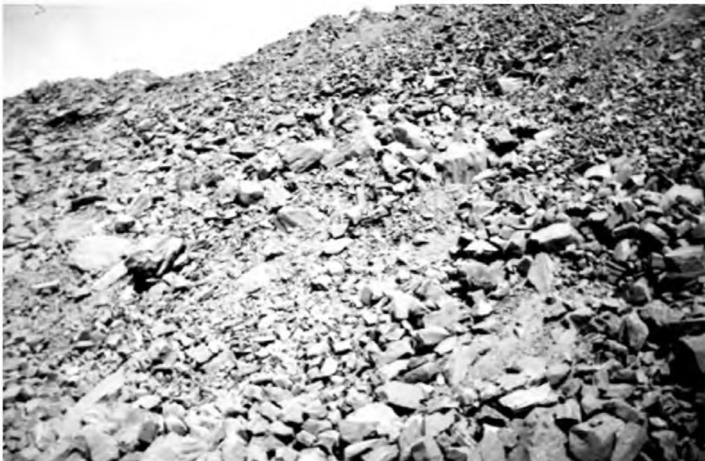
*Рис. 2. Дробление взорванной горной массы в блоке №18*
