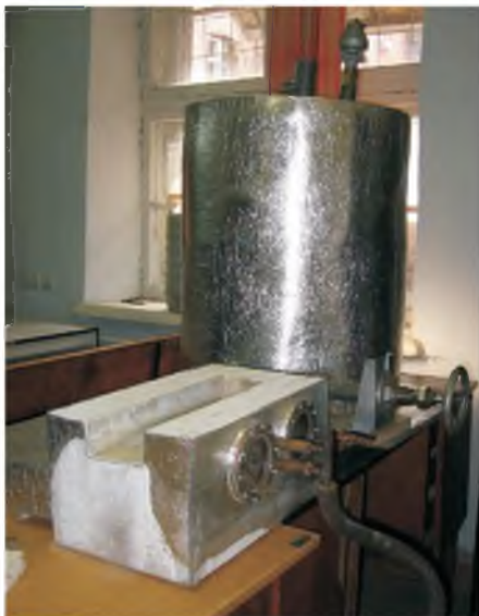
Рис. 2. КриоБласт™-1 — прототип устройства для сверхбыстрого охлаждения с ручным управлением (первое поколение).
