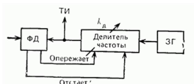
Рисунок 2.5 Структурная схема устройства синхронизации, использующего делитель частоты с переменным коэффициентом деления
