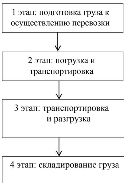
Рисунок 2.1.2 – Этапы технологического процесса перевозки грузов
