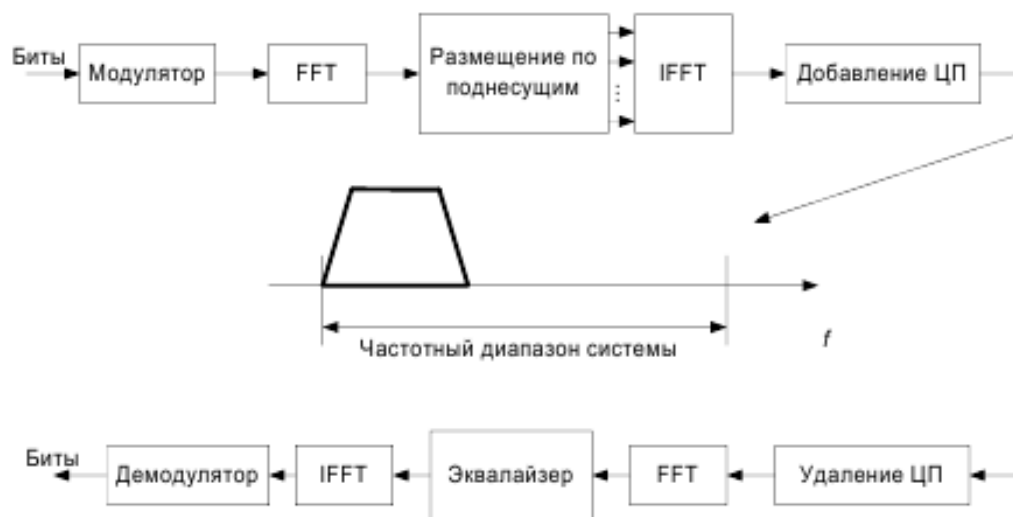
Рисунок 8 – Передача данных с использованием технологии SC-FDMA
