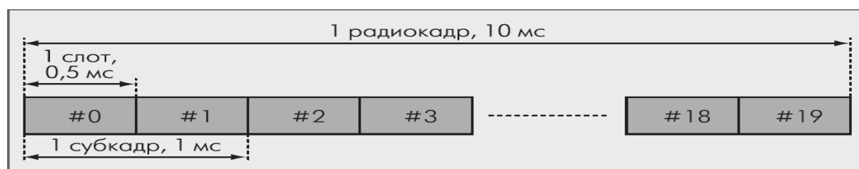
Рисунок 2.2 – Структура кадра LTE при частотном разделении дуплексных каналов
