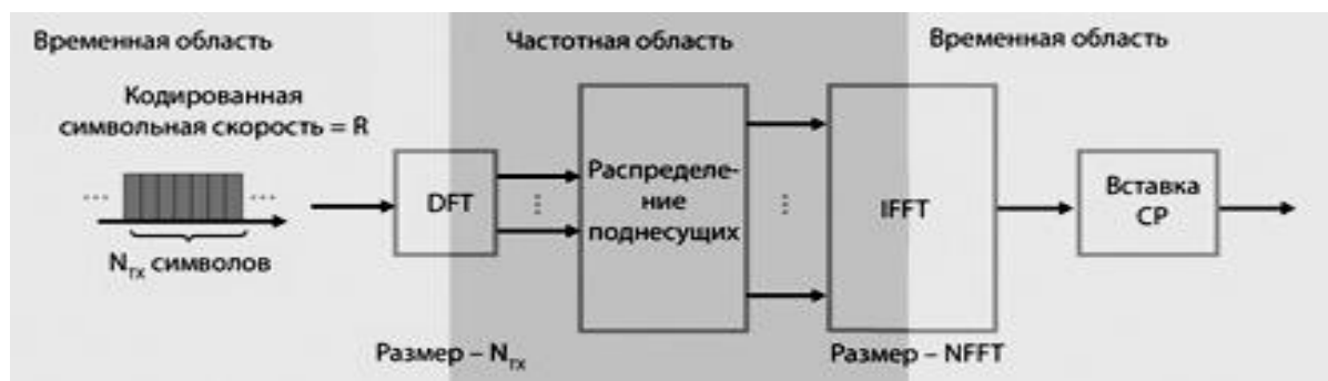
Рисунок 2.7 – Структурная схема генерации сигнала SC-FDMA
