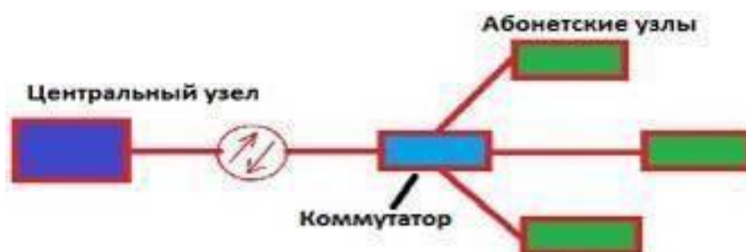
Рисунок 2.7 – Топология «дерево с активными узлами»
