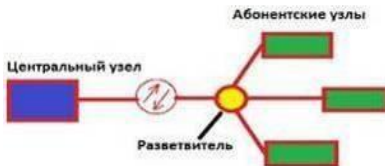
Рисунок 2.8 – Топология «дерево с пассивным оптическим разветвителем»
