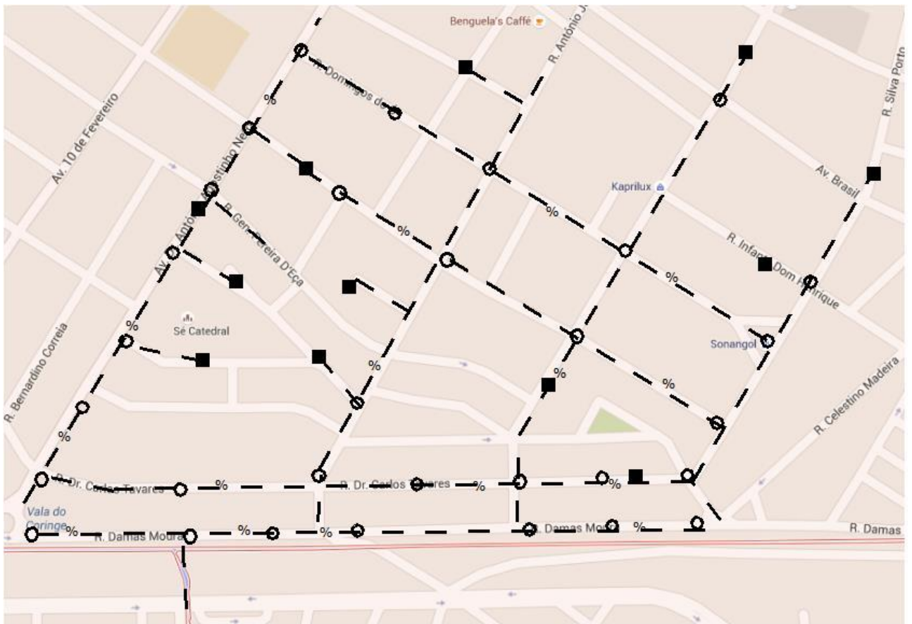
Рисунок 5.2 – Схема трассы прокладки кабеля в районе Бенгела г. Бенгела республики Ангола
