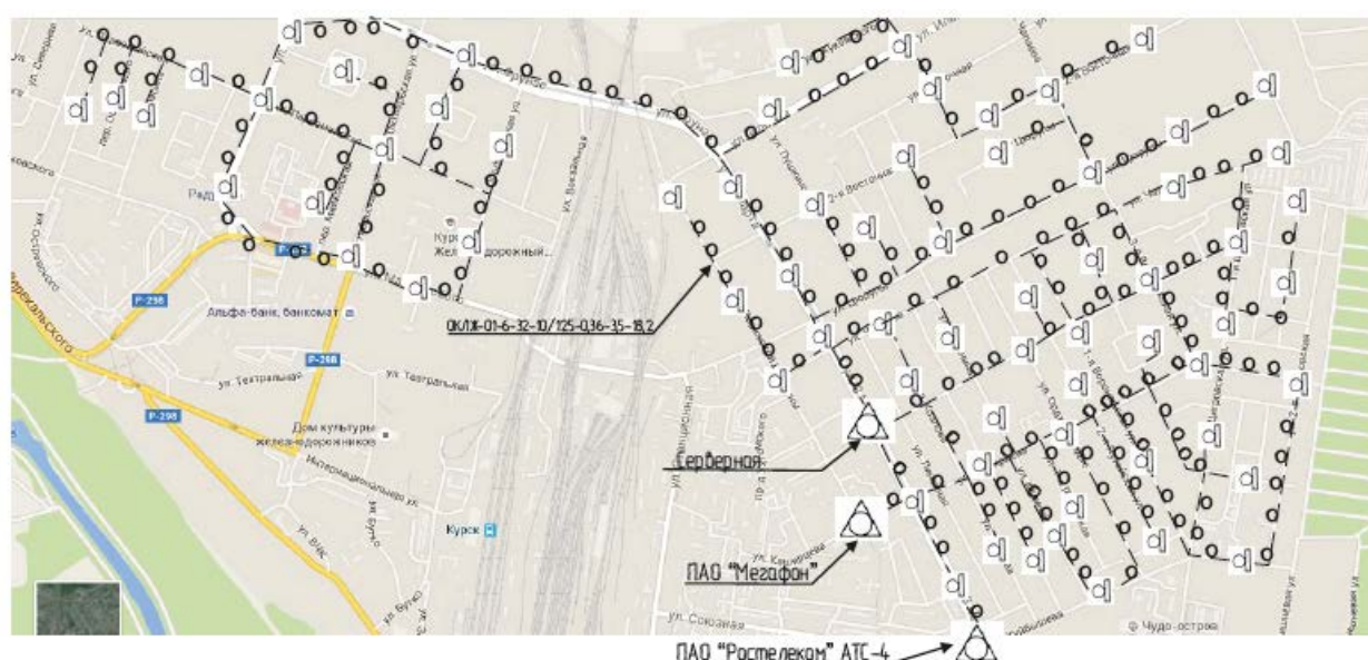
Рисунок 6.2 – Проектируемая схема трассы прокладки кабеля
