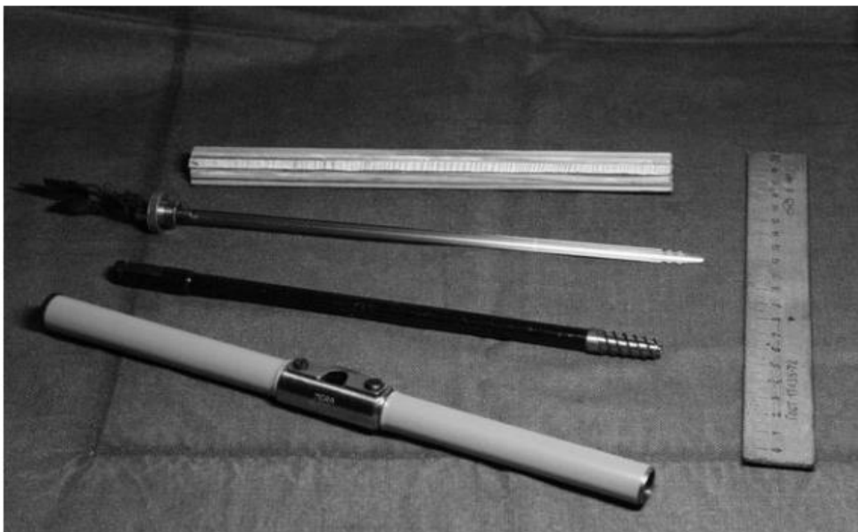
Рис.2.3. Возрастной бур «Haglof» с экстрактором [28]
