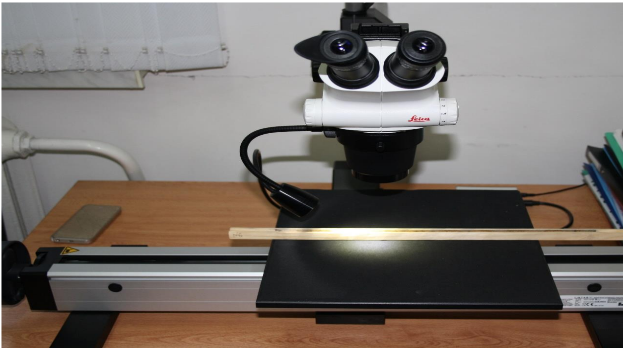
Рис. 2.4. Устройство для измерения годичных колец LINTAB-6 ( Фото Васёкина
