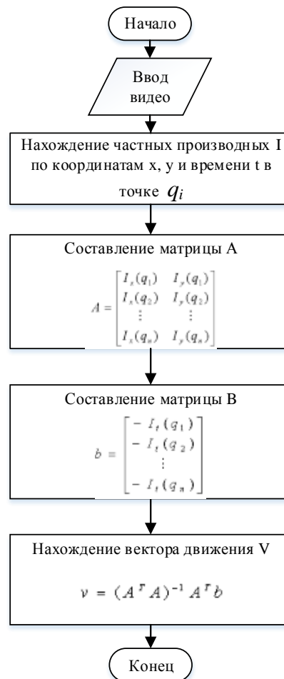
Рисунок 3.3 – Блок-схема алгоритма Лукаса-Канаде для вычисления оптического потока
