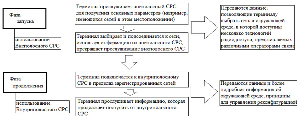
**Рисунок 2.5 - Процесс работы терминала с контрольным каналом**
