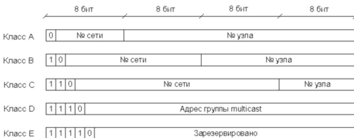
Рисунок 1.5 – Структура IP-адреса разных классов
