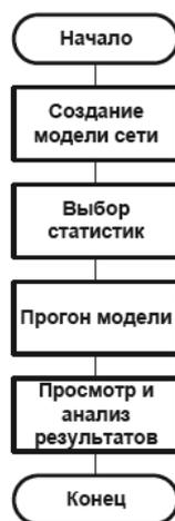
Рисунок 2.2 – Алгоритм работы с программной системой Riverbed Modeler
