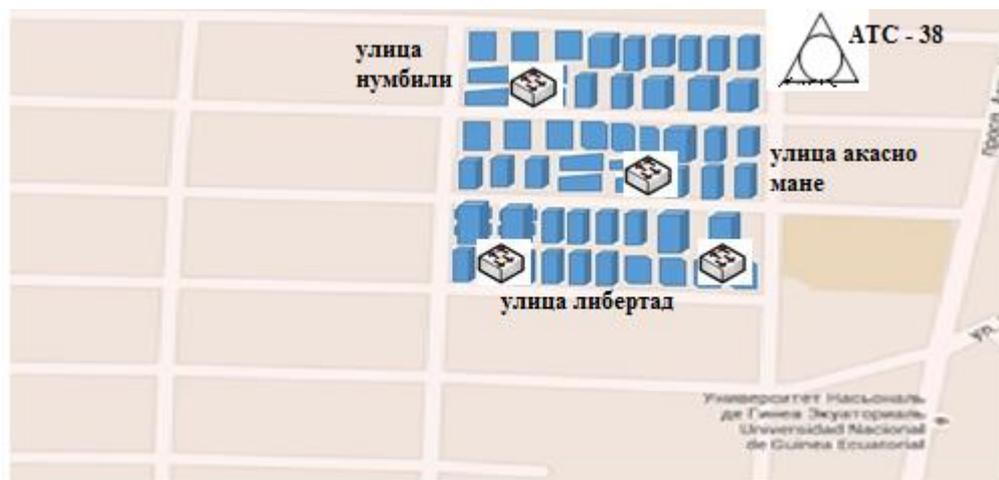
Рисунок 6.2 – Схематичное территориальное расположение коммутаторов
