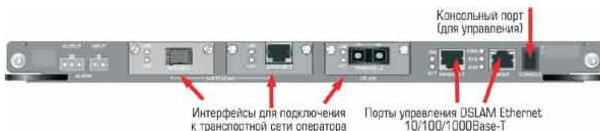
Рисунок 6.4 - Модуль управления и коммутации IP DSLAM
