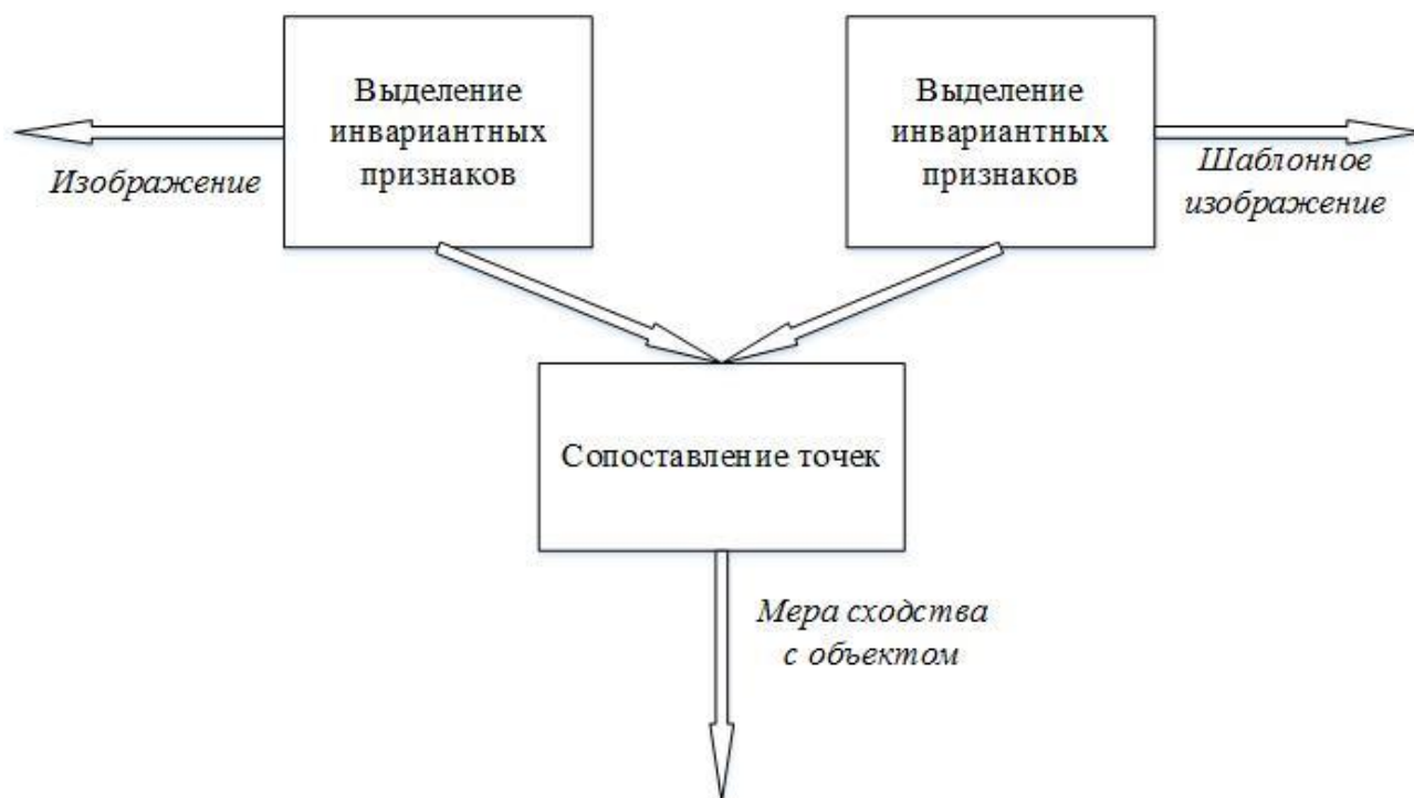
Рисунок 2.1 - Схема решения задачи детектирования объектов с использованием методов поиска объектов по шаблону
