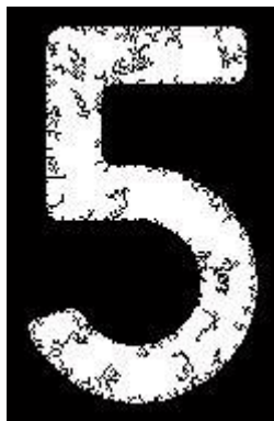
Рисунок 3.12 – Распознавание признака на основе наложения на его шума при 0.9: а) наложение шума; б) вывод результата при пороговой обработке
