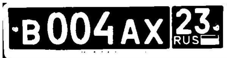
Рисунок 3.4 – Пороговая бинаризация: а) исходное изображение; б) полученное бинарное изображение с порогом 0.5
