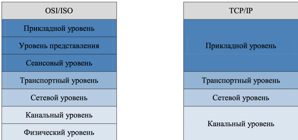
Рисунок 1.7 – Модель OSI/ISO и стек протоколов TCP/IP
