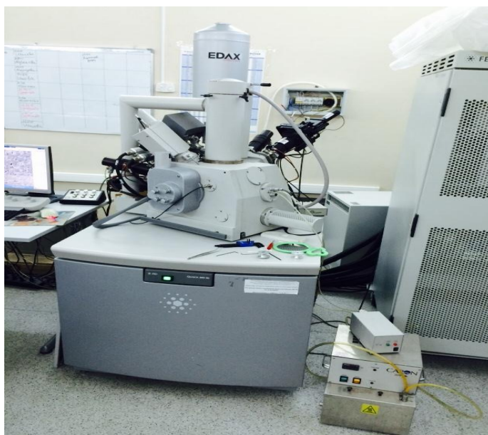
Рисунок 2.2 2. Растровый электронный микроскоп quanta 200 3D №AL40-D8069
