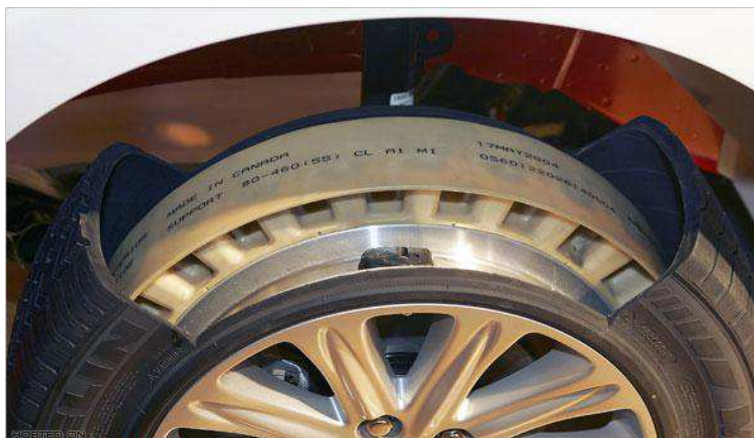
Рис. 2.3. Автомобильная шина в разрезе, выполненная по технологии «Run Flat»
