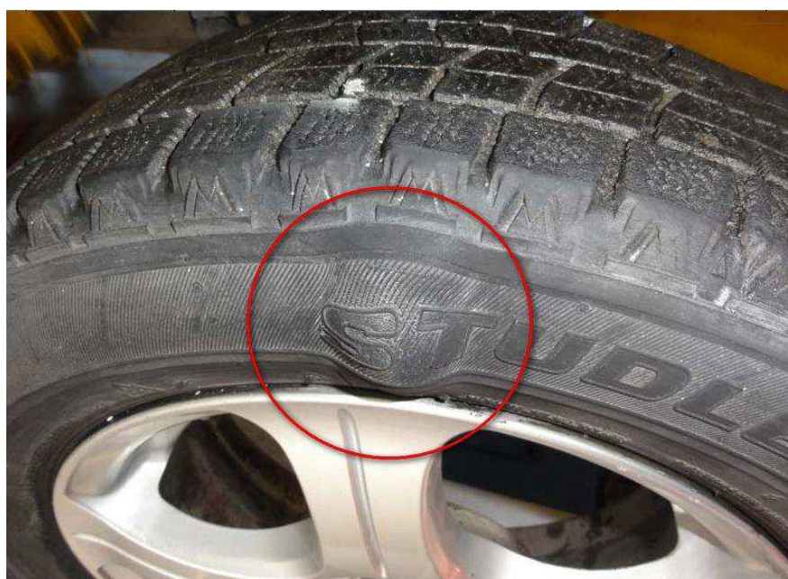
Рис. 1.1. Изображение вздутия (кила) на автомобильной шине
