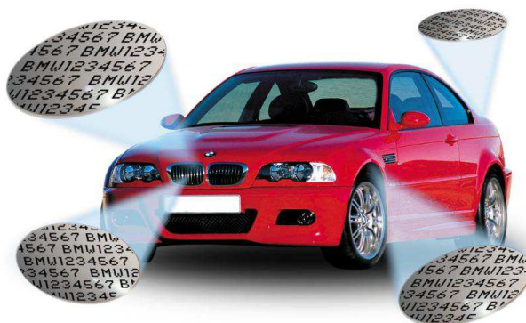
Рис. 2.7. Маркировка «Литэкс», выполненная на элементах светосигнальной арматуры транспортного средства
