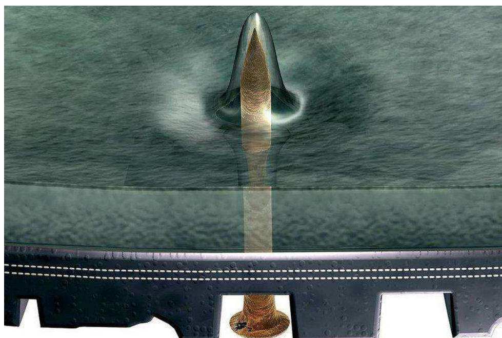
Рис. 2.4. Схематическое изображение автомобильной шины, выполненной по технологии «S-Concept»
