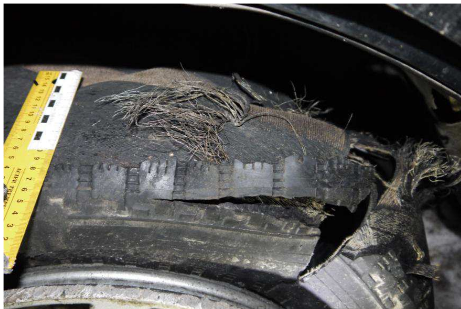
Рис. 2.2. Повреждения задней правой шины а/м Land Rover Discovery 3
