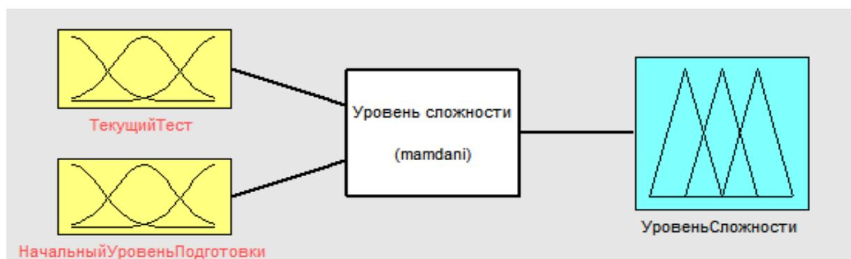
Рис. 3.6. Укрупненная схема системы нечеткого логического вывода Мамдани
