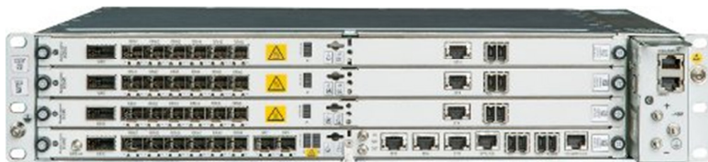
Рисунок 5.1 – Внешний вид Alcatel-Lucent 9926 eNodeB
