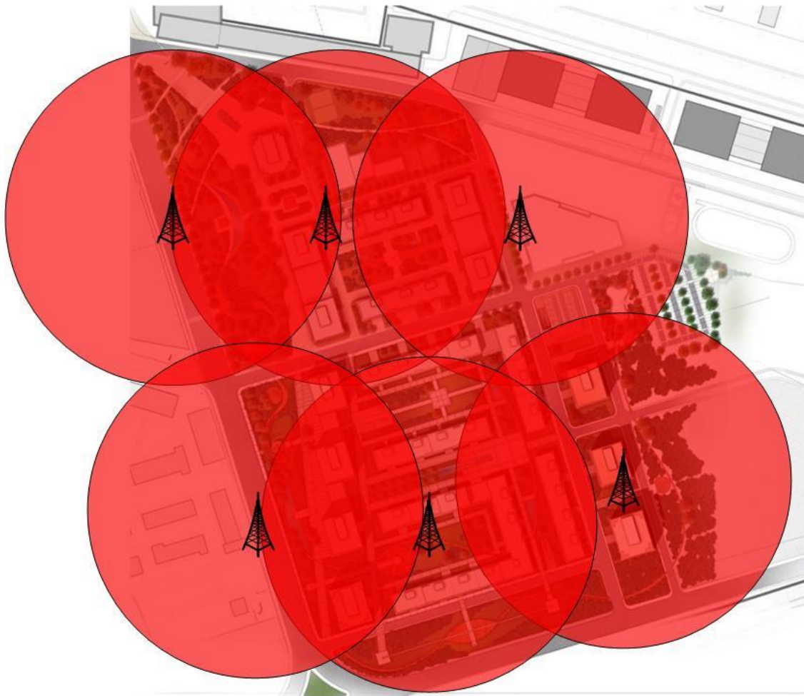
Рисунок 3.1 – Зона покрытия беспроводной сети на территории ЖК
