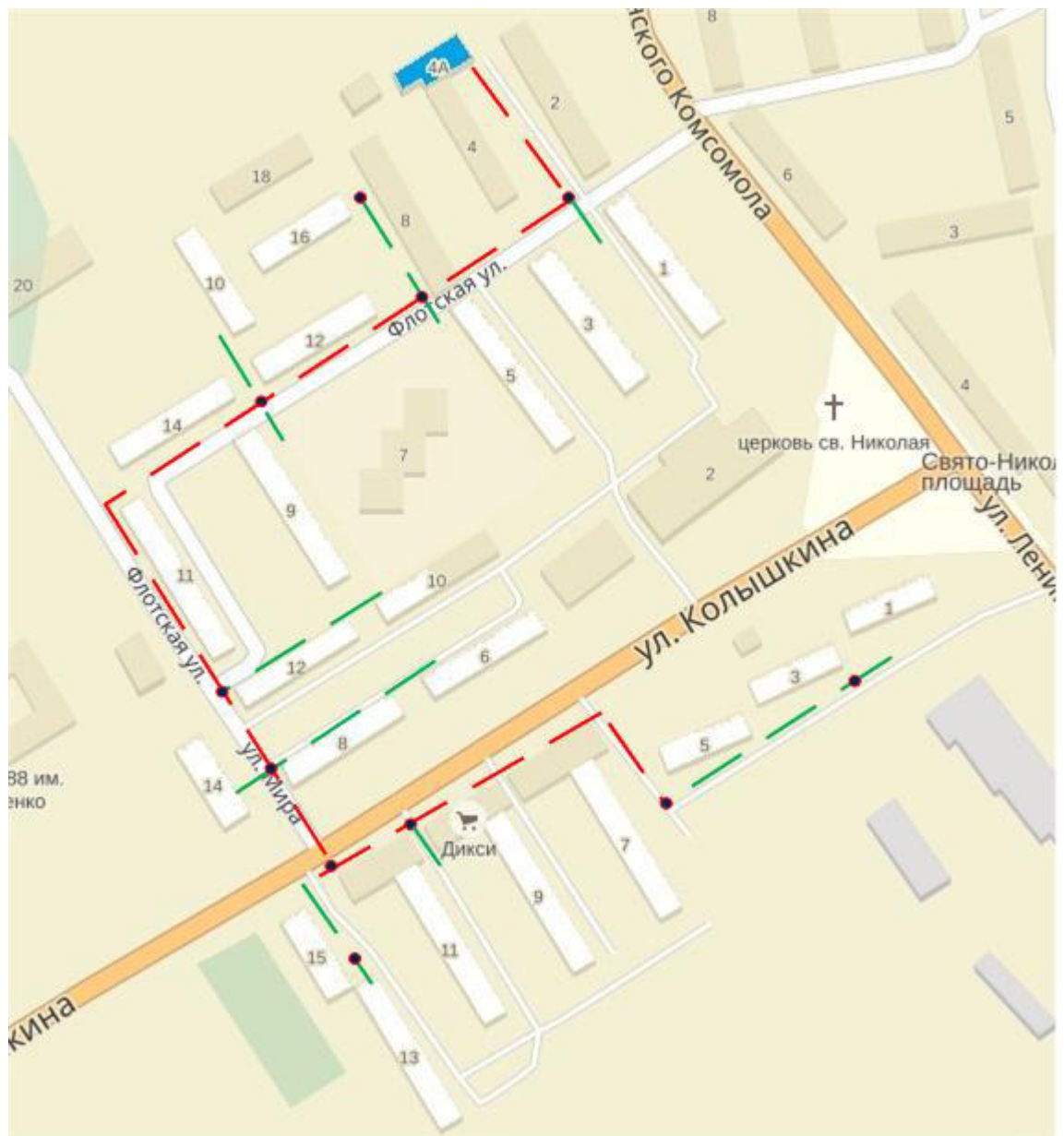
Рисунок 4.7 – Ситуационная схема трассы прокладки кабеля (Фрагмент 1).
