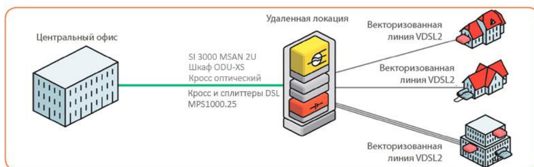
Рисунок 4.2 – Типовое применение технологий FTTC и VDSL2
