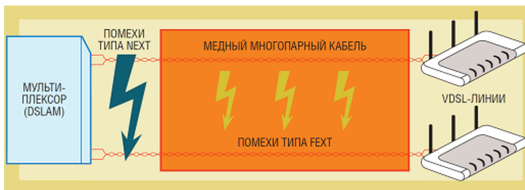
Рисунок 4.3 – Схема образования помех в медном многопарном кабеле
