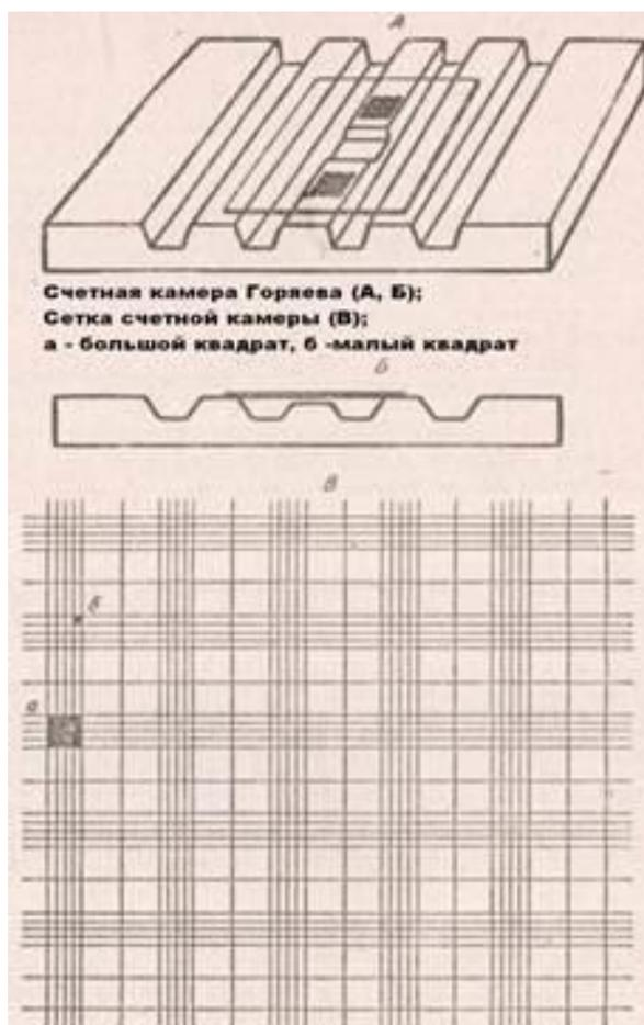
Рисунок 2.1 – Счетная камера Горяева
