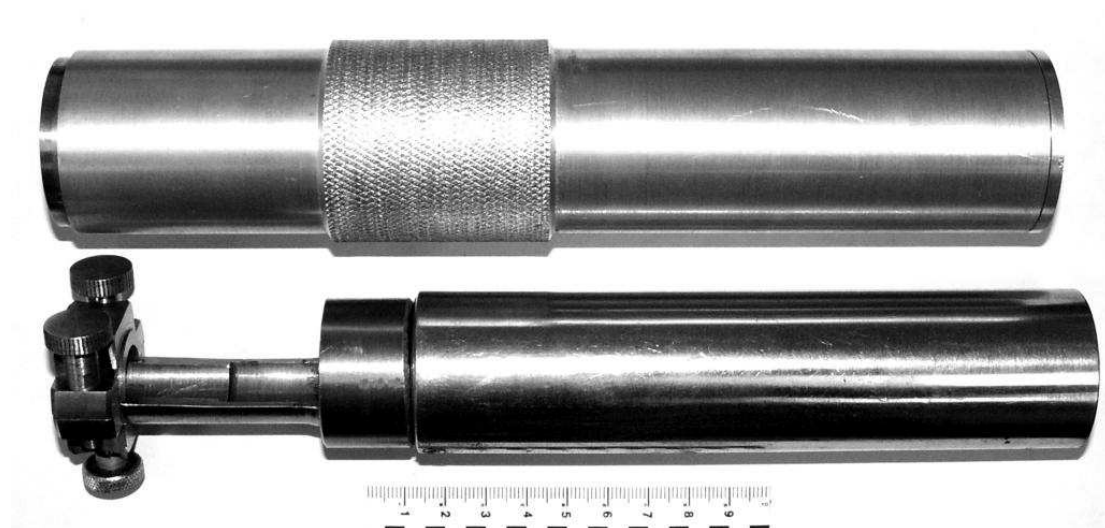
Рис. 2.1. Два неразборных глушителя, представленных на исследование
