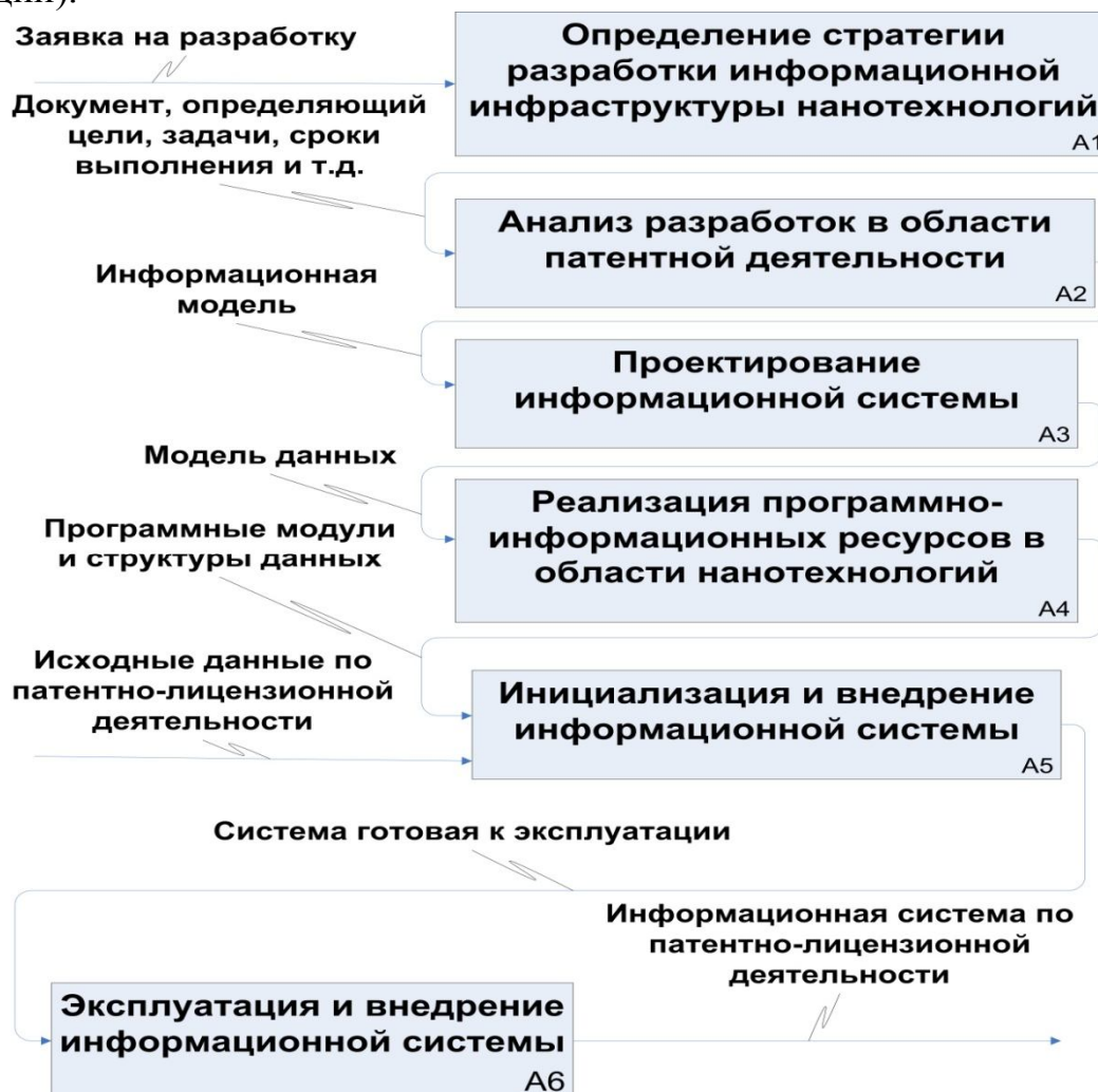
Рис.1. Процедура проектирования и разработки информационной инфраструктуры нанотехнологий
