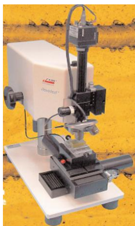
Рисунок 8 Скретч-тестер РЕВТЕСТ: а) внешний вид, б) устройство, в) схема испытания на приборе РЕВТЕСТ
