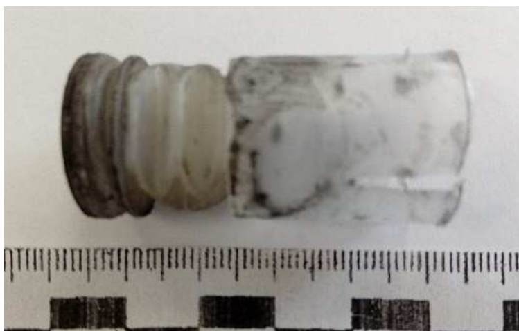
Рис.3.17. Экспериментальный образец, выстреленный из гладкоствольного оружия 12 калибра МР-125.
