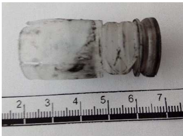
Рис.3.13. Исследуемый пыж – контейнер, выстреленный из гладкоствольного оружия 12 калибра ТОЗ-34.
