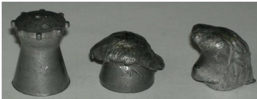
Рис.3.12. Деформация головной части пули
