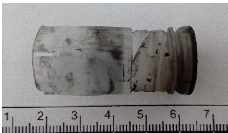
Рис.3.14. Экспериментальный образец, выстреленный из гладкоствольного оружия 12 калибра ТОЗ-34.
