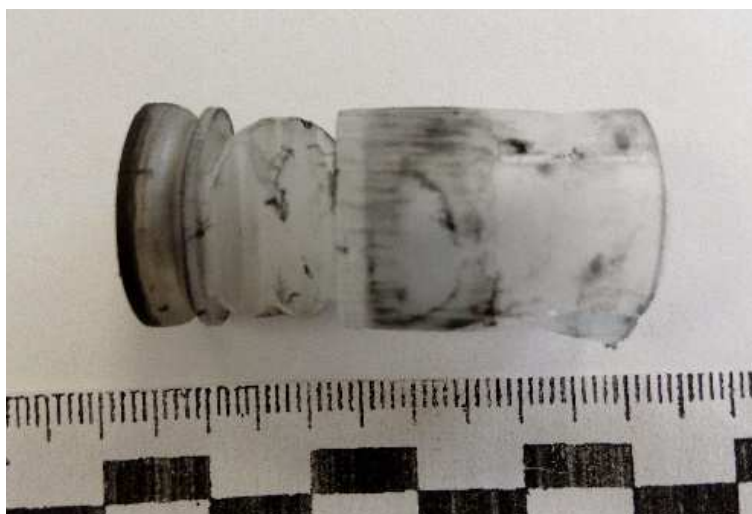
Рис.3.19. Экспериментальный образец, выстреленный из гладкоствольного оружия 12 калибра ИЖ-27.
