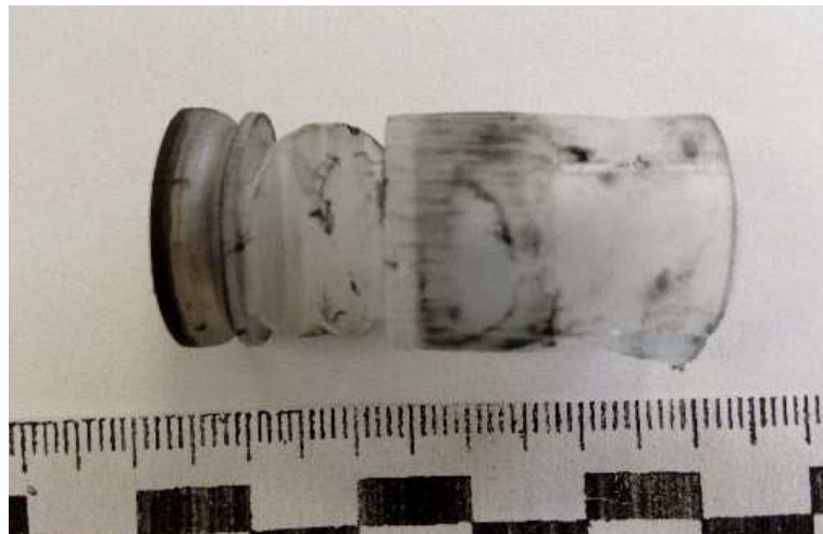
Рис.3.16. Исследуемый пыж – контейнер, выстреленный из гладкоствольного оружия 12 калибра МР-125.
