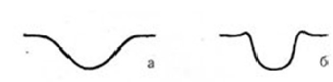
Рис. 3.7. Профиль следа бойка на капсюле: а - при осечке; б - при выстреле.
