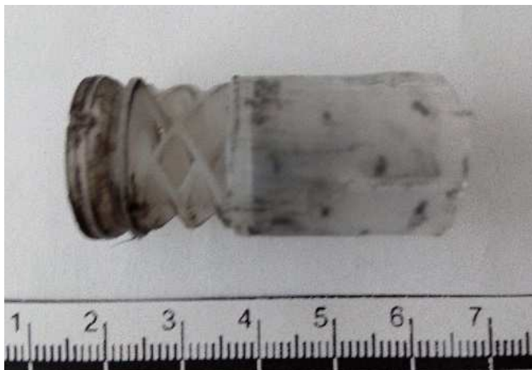
Рис.3.19. Исследуемый пыж – контейнер, выстреленный из гладкоствольного оружия 12 калибра ИЖ-27.
