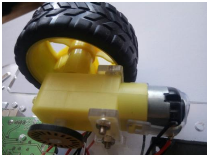
Рис. 3.2. Мотор-редктор на 6-12В с установленным колесом
