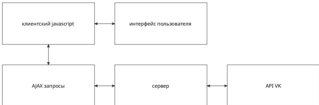
Рис. 2.2 - Схема общего принципа работы клиентской части, серверной части и API VK.
