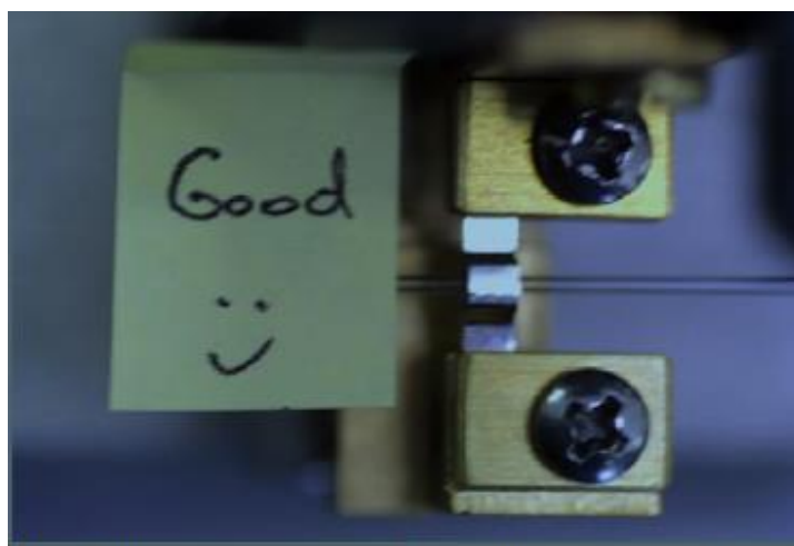
Рис. 29. Правильно установленный нагревательный элемент.
