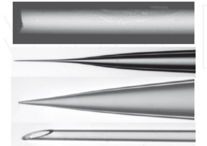
Рис 11. Изображения электронной и оптической микроскопии предварительно обработанных (верхних) и условно обработанных капилляров.
