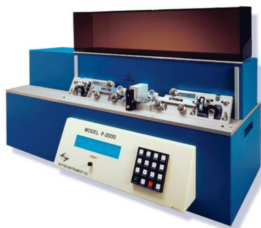
Рис. 23. Пуллер Р 2000 компании Sutter Instrument
