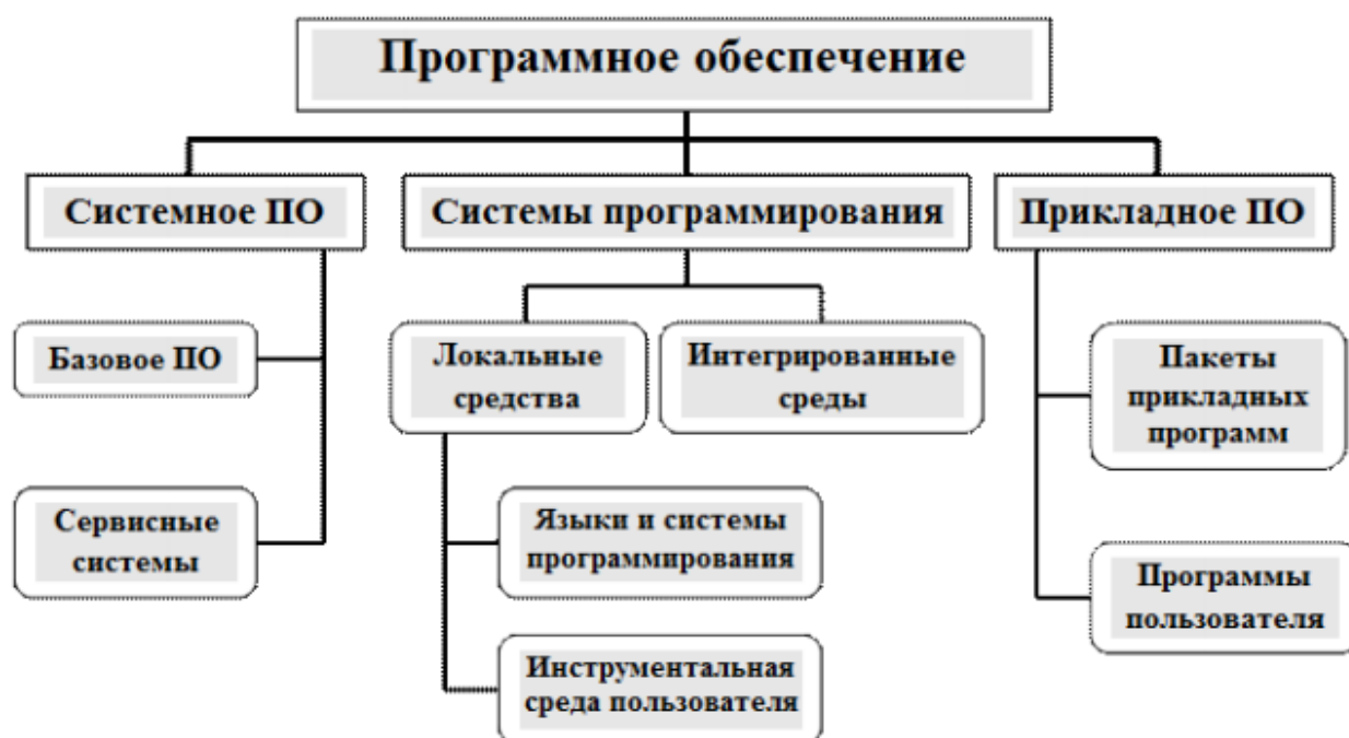
Рисунок 2.4 – Структура программного обеспечения
