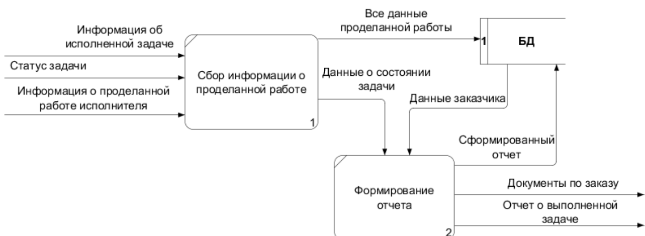
Рисунок 2.9 – Диаграмма декомпозиции функционального блока «Составление отчетности»
