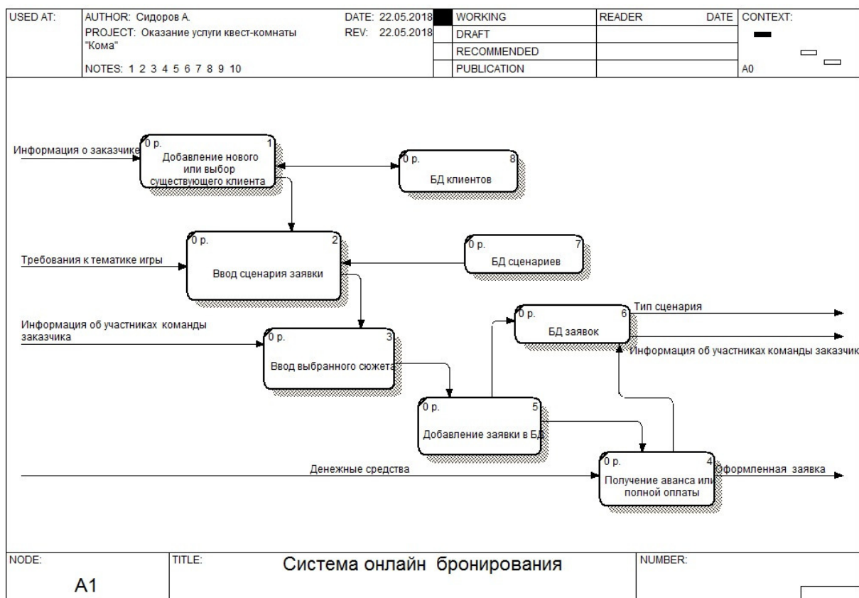
Рисунок 3.2 – Декомпозиция блока «Система онлайн бронирования» в нотации DFD
