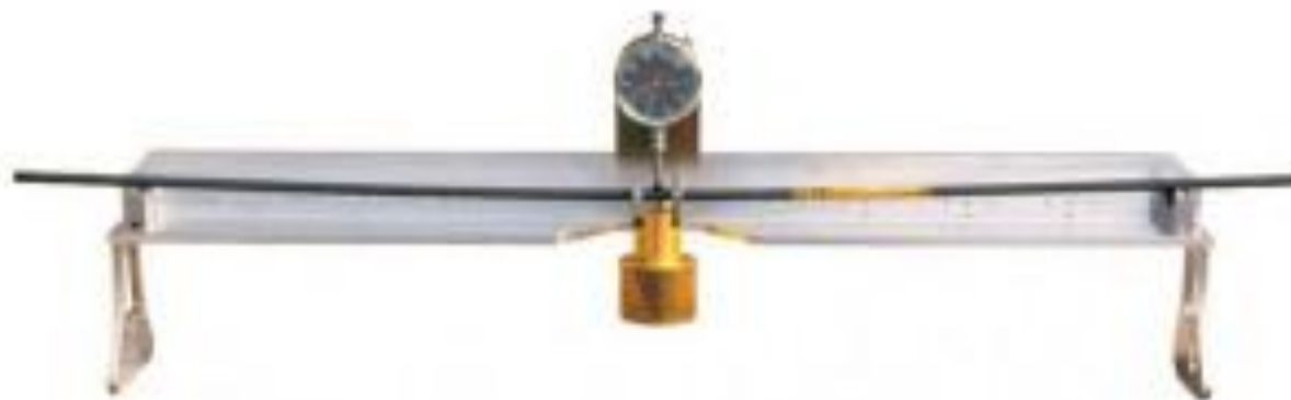
Рис. 6. Методика замера спайна стрелы.
