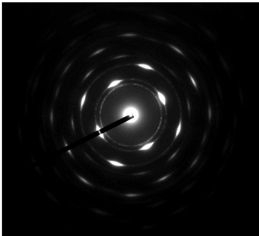
Рисунок 23. Электронограмма покрытия \text{Ti:V} , полученная в режиме дифракции с помощью ПЭМ JEM 2100
