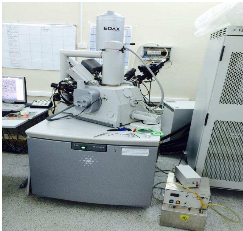
Рисунок 13. Растровый электронный микроскоп Quanta 200 3D №AL40-D8069
