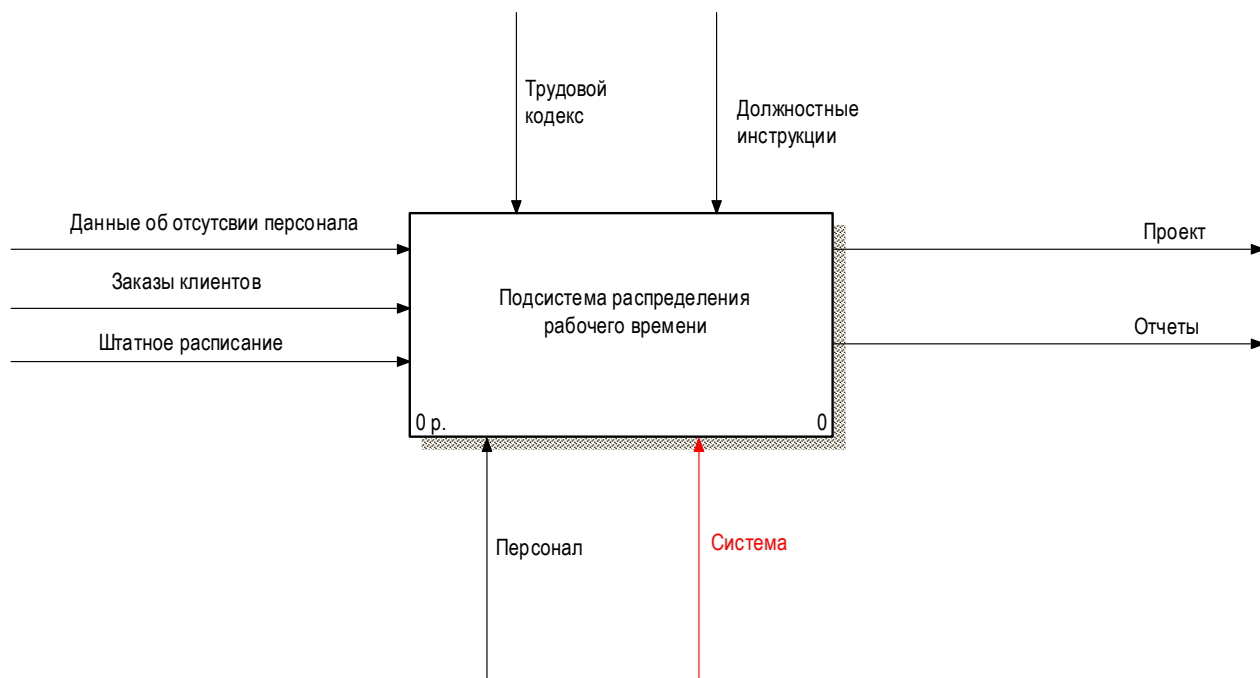
Рисунок 2.1 – Контекстная диаграмма процесса "Подсистема распределения рабочего времени" (IDEF0)
