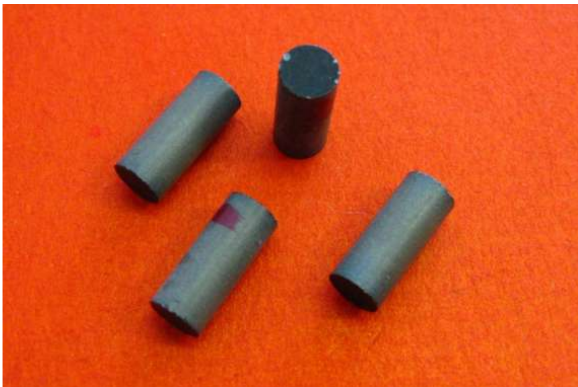
Рисунок 4 – Фотография пьезоэлектрических образцов, выполненных из материала ЦТБС-3М, используемых при исследовании нового эффекта
