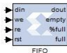
Рисунок 4.4 – Блок память «FIFO»
