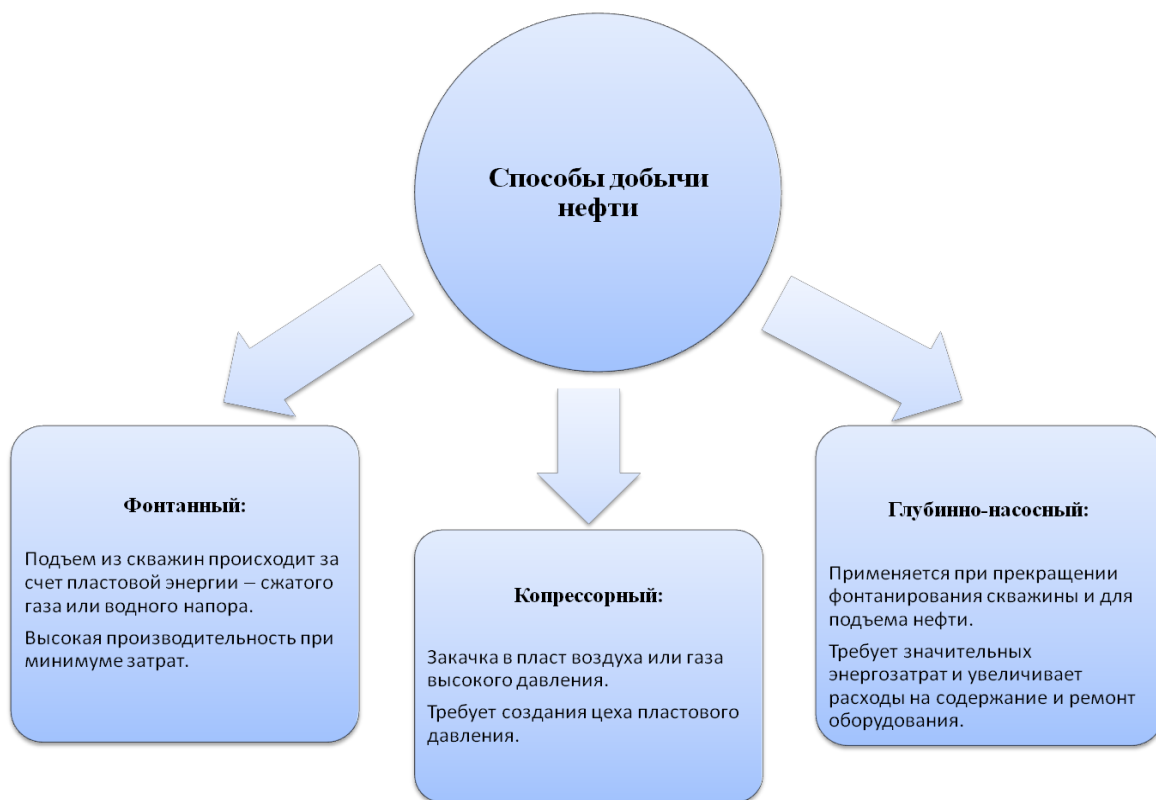
Рис. 2.3. Основные способы нефтедобычи
