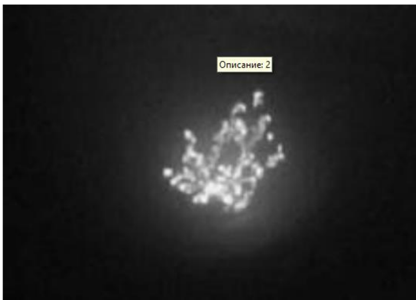
Рис. 1.7 Фотография катодных пятен на поверхности графитового катода [10]
