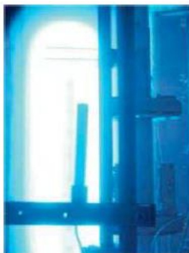
Рис.1.8 Снимок разряда HiPIMS, работающего на мишени 1200 \text{ см}^2 [11]
