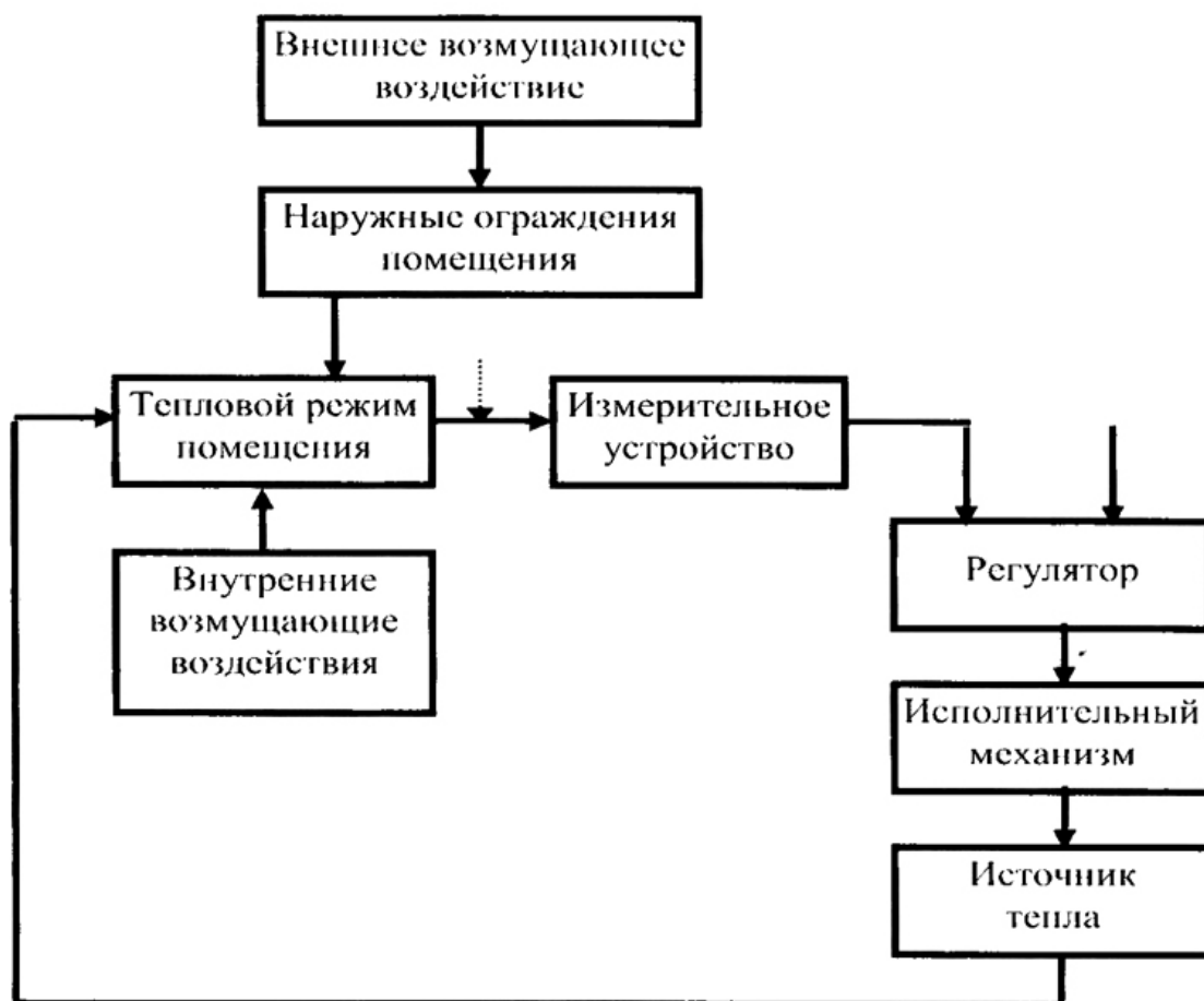
Рисунок 1.1 – Структурная схема управления тепловым режимом помещения по отклонению внутренней температуры помещения
