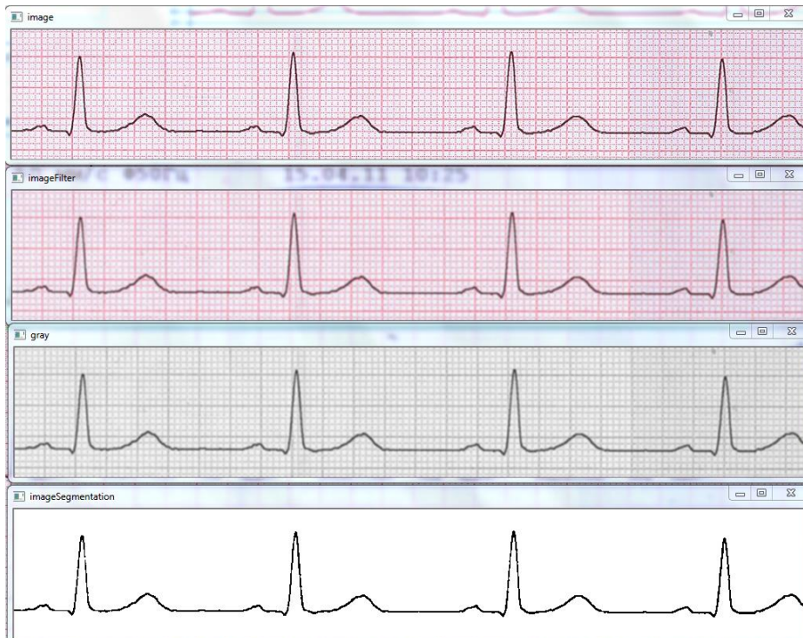
Рисунок 3.7. Этапы обработки ЭКГ
