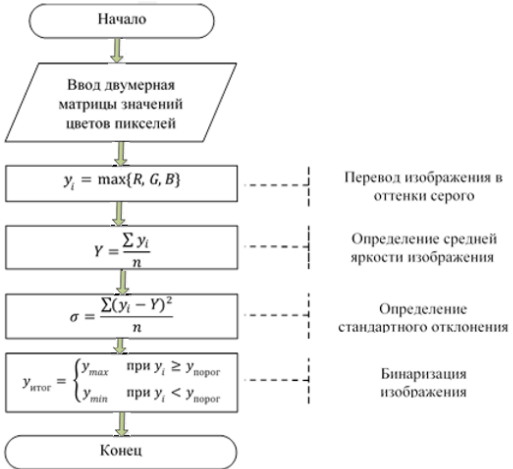
Рисунок 2.2 Схема алгоритма перевода в оттенки серого
