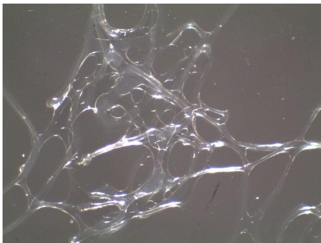
Рис. Хитозановые волокна без наночастиц. Стереомикроскоп
