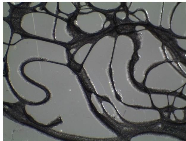
Рис. Хитозановые волокна с наночастицами оксида железа (III). Стереомикроскоп
