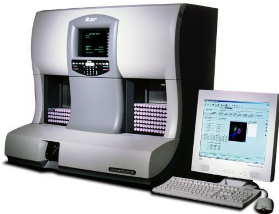
Рис. 1. Гематологический анализатор COULTER LH 750 (Beckman Coulter, США).
