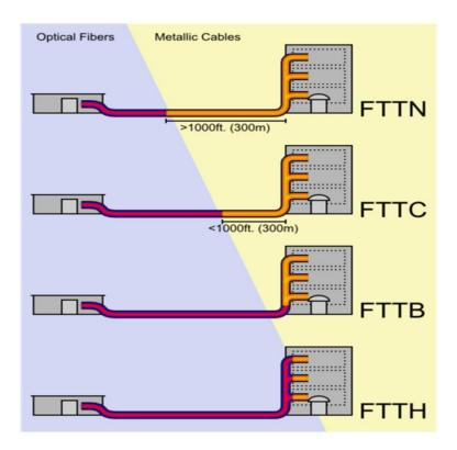
Рисунок 7 - Схема, иллюстрирующая различия архитектур FTTx
