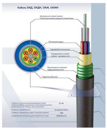
Рисунок 9 – Оптический кабель модульной конструкции марки ОКДН
