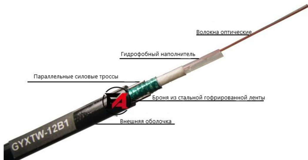
Рисунок 4.2 – Вид кабеля ТОЛ-П-24-У-3-6-2,7кН (GYXTW )
