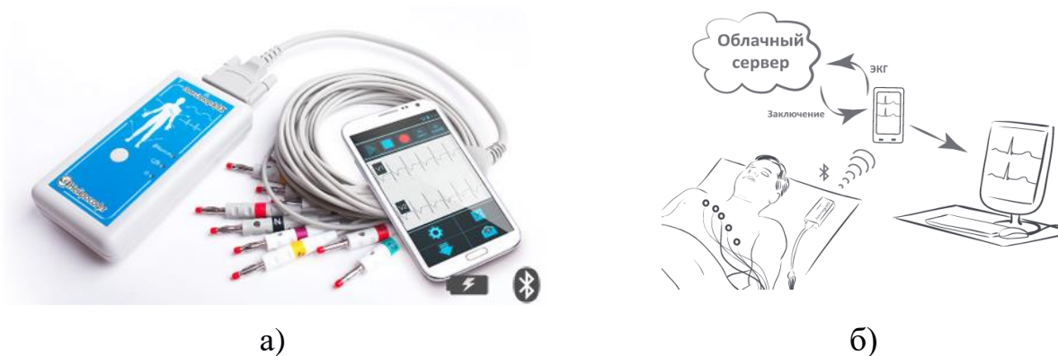
Рисунок 1.5 – Кардиограф «ПОЛИ-СПЕКТР-8G»: а) внешний вид; б) схема взаимодействия звеньев системы
