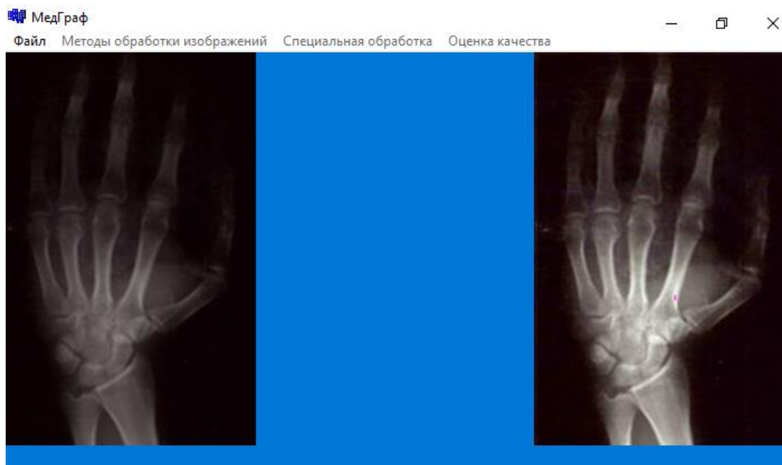
Рисунок 45 – Результат применения эквализации гистограммы
