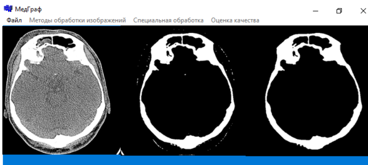
Рисунок 48 – Результат применения морфологического фильтра
