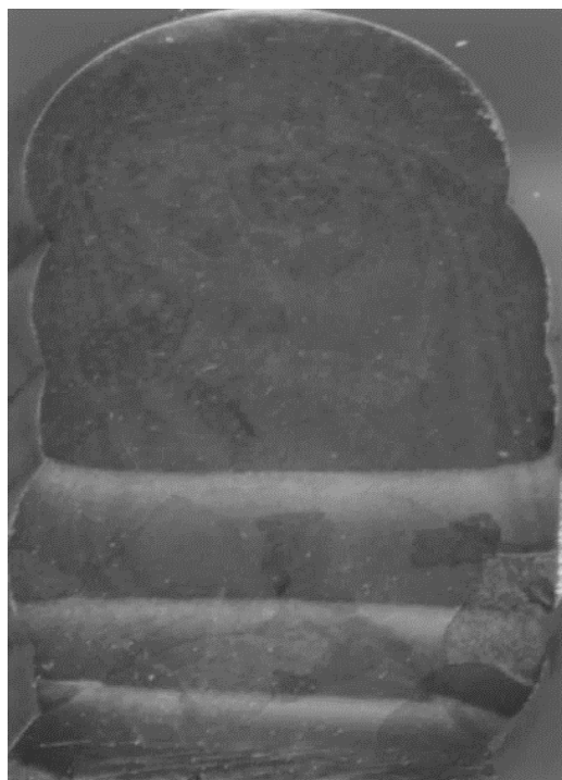
Рис. 3.5 – Сканированное изображение макрошлифа образца сплава ВТ6, наплавленного с использованием проволоки производства ЧМЗ
