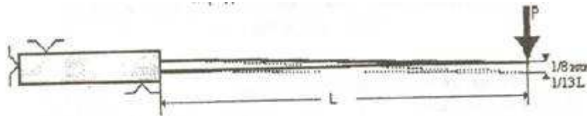
Рис. 2.2. Схема проведения испытаний на прочность и упругость кинжалов, предназначенных для ношения с казачьей формой и национальными костюмами народов РФ
