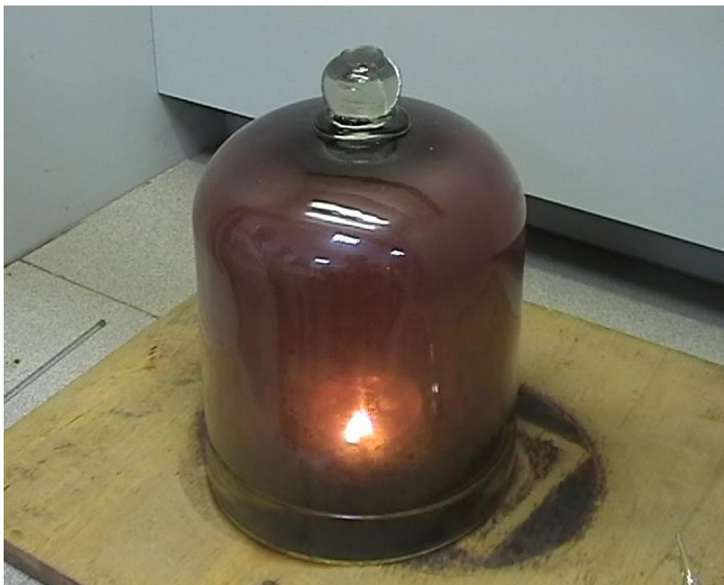
Рис. 6. Взаимодействие алюминия с иодом
