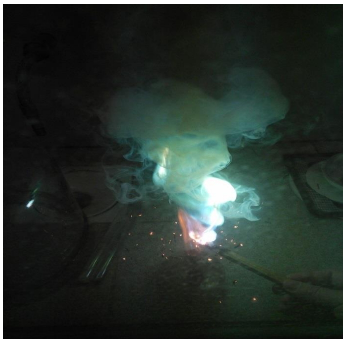
Рис. 7. Взаимодействие алюминия с серой
